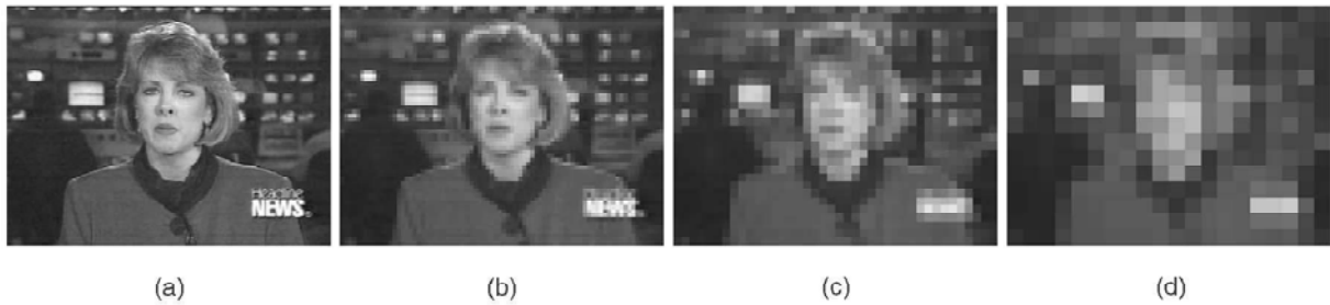
شکل ۳-۳۹: (چپ) n = 1 تصویر اصلی (دوم) n = 4 (سوم) n = 8 (راست) n = 16 . تصویر اصلی و تصاویر متناظر آن با دقت پایینتر. هر سلول مربعی شامل n \times n پیکسل است که شدت آن برابر میانگین شدت روشنایی پیکسلهای آن سلول است.
